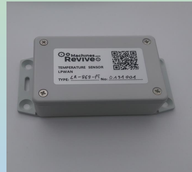
Urządzenie sensoryczne (8x5cm) do pomiaru temperatury z radiowym interfejsem LPWAN LoRa – wersja z anteną wewnętrzną, bez klatki pomiarowej
