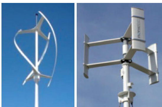
Rysunek 22 Turbiny o pionowej osi obrotu 206
