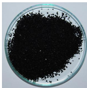
Rys. 17. Stan próbki granulatu z nawierzchni boiska sportowego przy Szkole Podstawowej Nr 35, nr 623/18/P2
