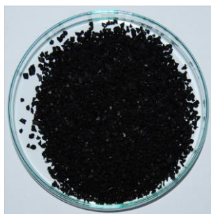
Rys. 15. Stan próbki granulatu z nawierzchni boiska sportowego przy Szkole Podstawowej Nr 14, nr 622/18/P2
